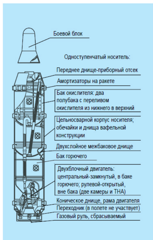
Компоновочная схема ракеты Р-27
